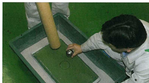
落球衝撃試験 比較資料(1kg鉄球 1m)
